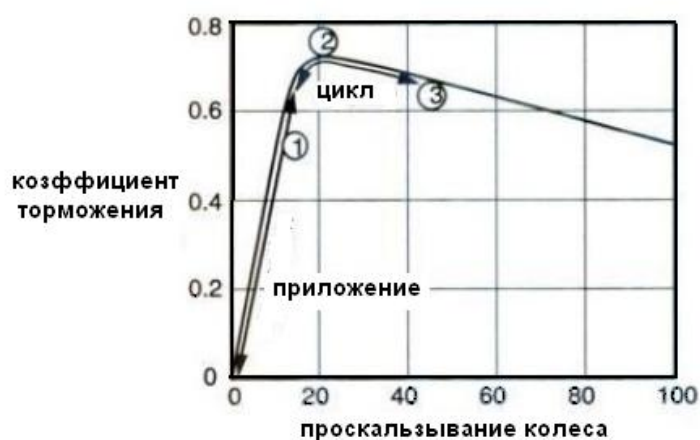
Рис. 1.10: Процесс АБС достижения максимальной силы торможения
